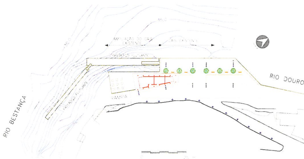
Figura 10 - Alternativa 3. Ampliação do cais com estrutura flutuante
