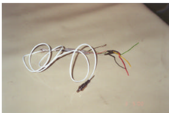
Fot.1 – Transdutor de pressão
