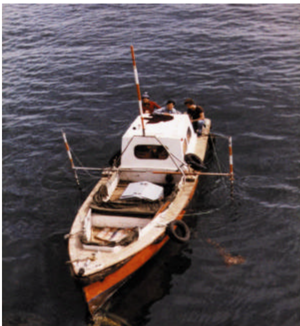
Figura 4 – Embarcação de sondagem com dois transdutores.
