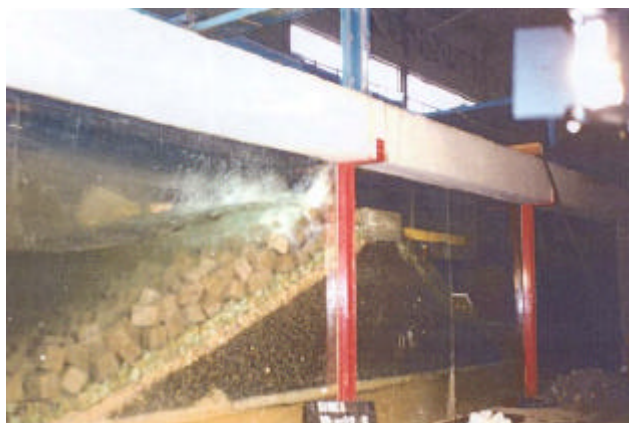
Figura 8 – Ensaios do perfil-tipo em modelo físico bidimensional (canal de ondas do LNEC)
