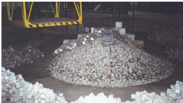
Figura 9 – Ensaio modelo físico tridimensional (tanque de ondas do LNEC; modelo em fase de construção)
