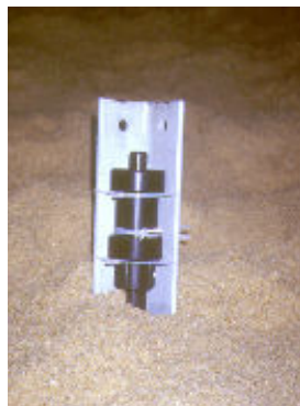
Figura 1. Pormenor de um dos transdutores de pressão, colocado na zona entre-marés.
