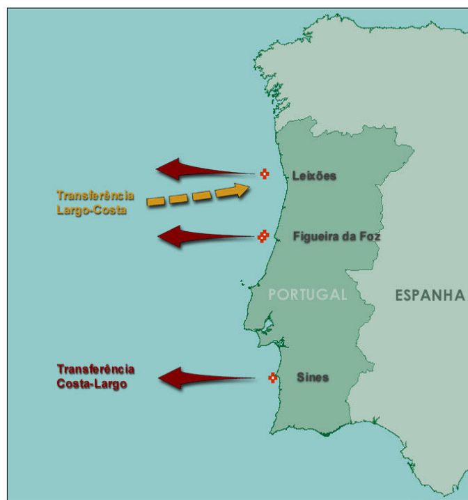
Figura 4. Transferência conceptual dos dados de agitação das bóias ondógrafos de Leixões, Sines e Figueira da Foz para o largo e, dessa região, para o ponto da bóia ondógrafo de Leixões.
