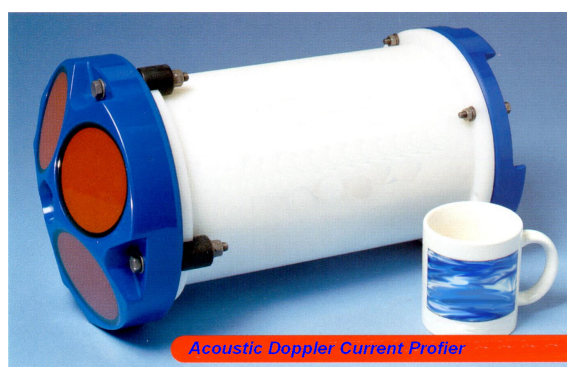
Figura 1 - Perfilador de correntes (ADCP) utilizado durante o projecto (RDI,2001, WorkHorse Sentinel ADCP User's Guide,)
