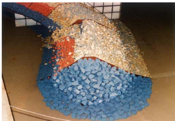
Fig. 2 - Aspecto dos estragos passíveis de ocorrerem no talude interior de quebra-mares, devido à intensidade dos galgamentos: a) cobertura fotográfica de uma tempestade onde se observam galgamentos de grande intensidade; b) fotografia de um modelo ensaiado no LNEC.
