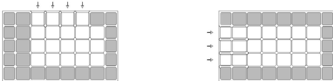
Alternativas da integração da CAO na cabeça do molhe; 1) abertura paralela ao corpo do molhe (esq.), 2) abertura ortogonal ao corpo do molhe (dir.)
