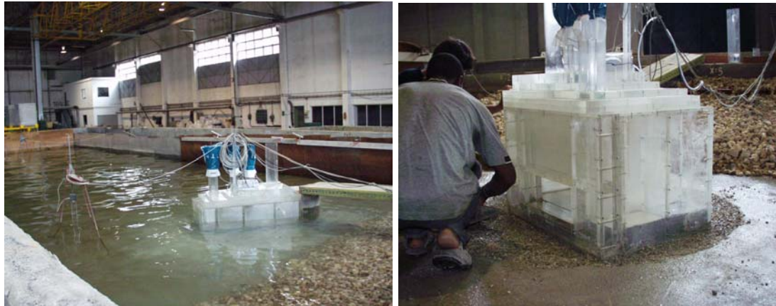
Figura 5 – Tanque de ensaios e prato rotativo onde se encontra modelo da Central.
