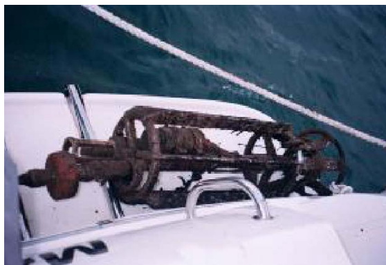
Fig. 8 - Estrutura de suporte do equipamento. Aspecto da mesma estrutura 20 dias após a sua colocação no local
