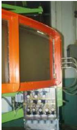
Fig. 5 - Canal para ensaio de sedimentos finos. Resultados de ensaio de erosão com sedimento de Alcochete
