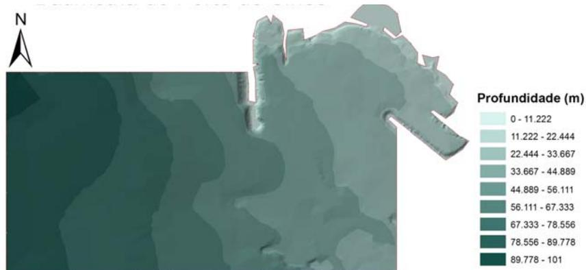
Figura 8. Batimetria 2D do Porto de Sines.
