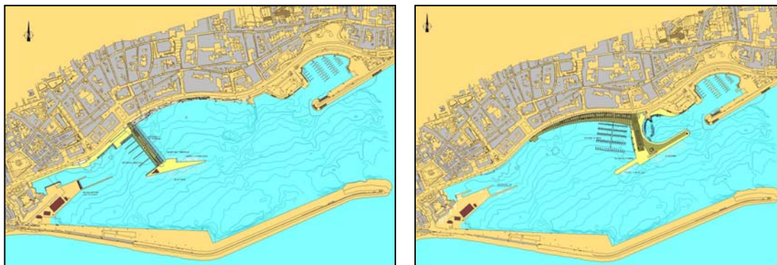
Fig. 1C – Plantas de localização de duas soluções alternativas para o Terminal de cruzeiros de Ponta Delgada
