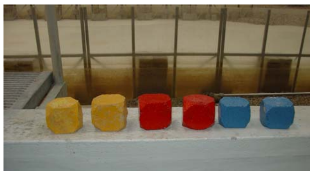
Figura 9 – Comparação entre os blocos de densidade normal (amarelos) e os de alta densidade (vermelhos e azuis).
