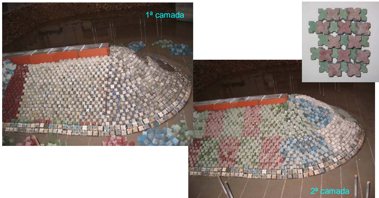
Figura 7 - Colocação regular dos blocos cúbicos Antifer. Blocos na 1ª camada (foto esquerda), blocos na 2ª camada (foto direita) e padrão de colocação dos blocos (foto superior direita)
