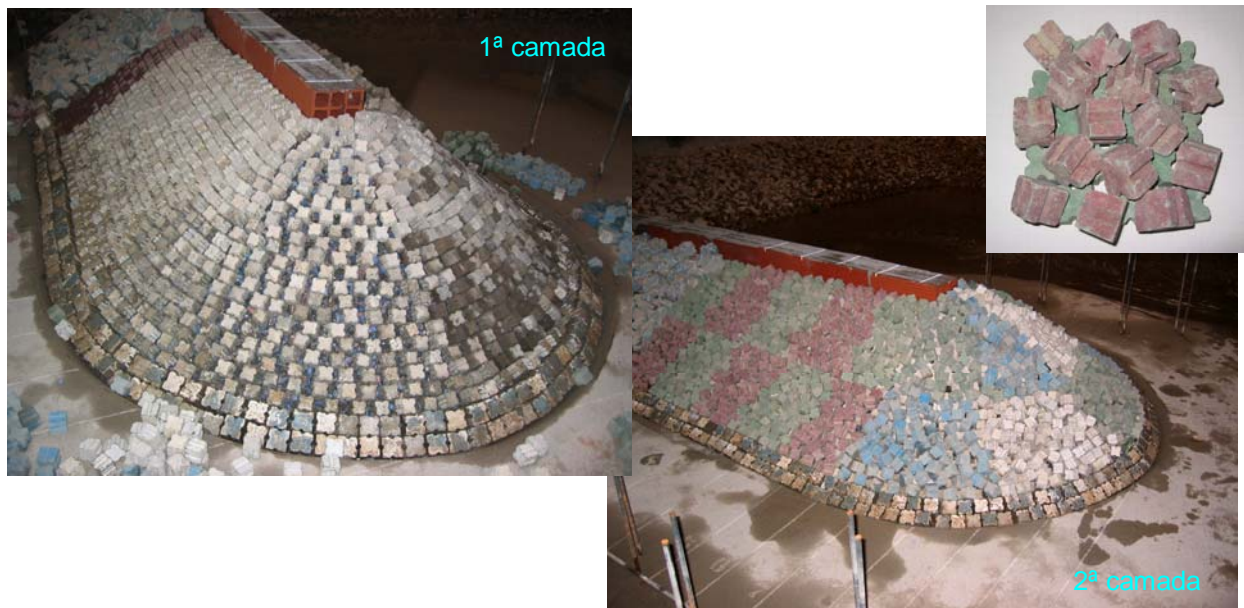
Figura 6 - Colocação irregular dos blocos cúbicos Antifer. Blocos na 1ª camada (foto esquerda), blocos na 2ª camada (foto direita) e padrão de colocação dos blocos (foto superior direita)
