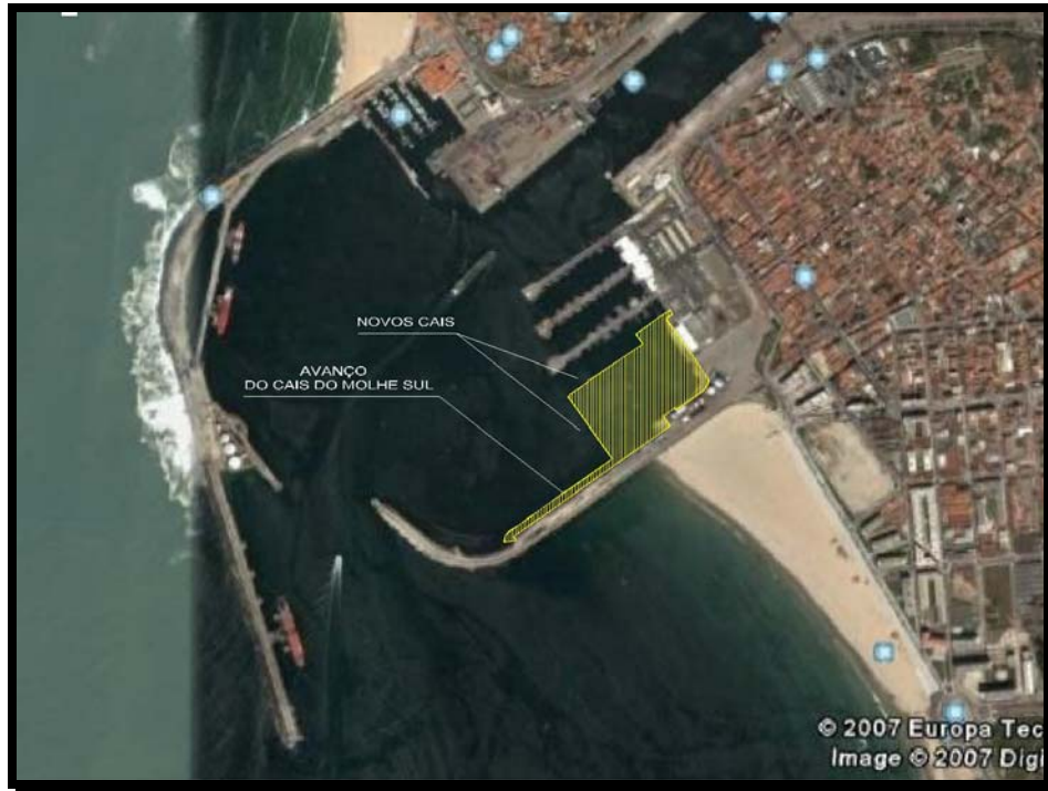
Fig. 8 – Implantação do novo Terminal Multiusos do Porto de Leixões
