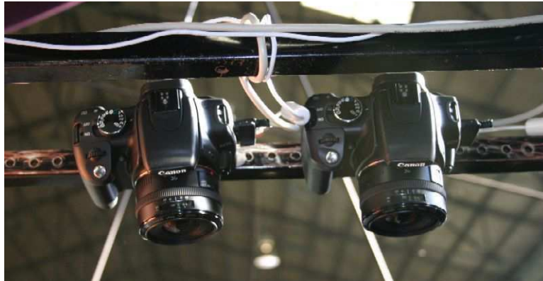
Figura 12 – Equipamento necessário para a obtenção de pares de imagens estéreo
