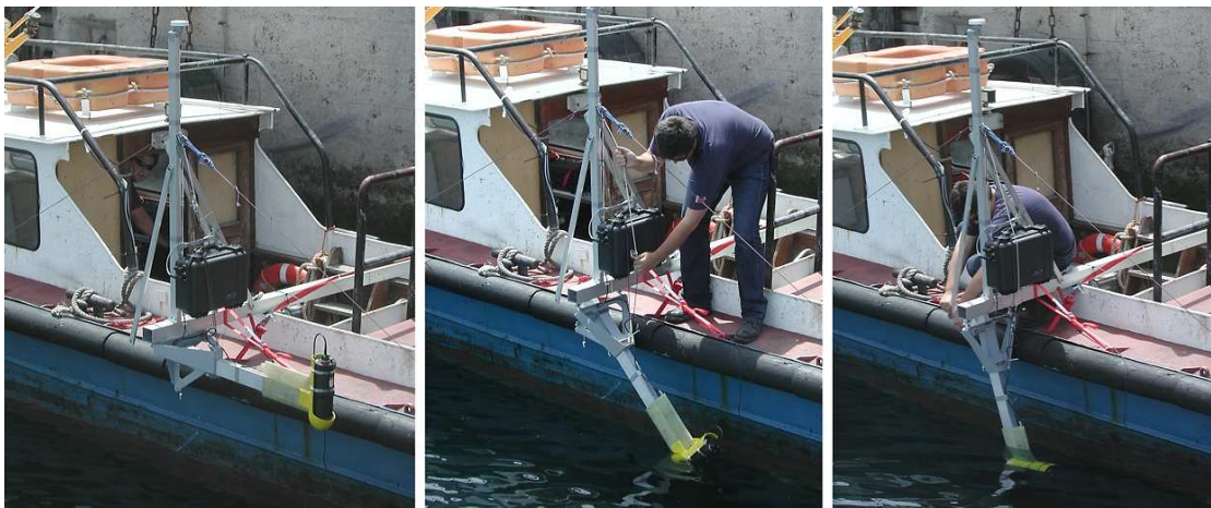
Figura 4 – O pré-protótipo do IRIS instalado numa das embarcações de trabalho do porto de Sines. Junho de 2003.
