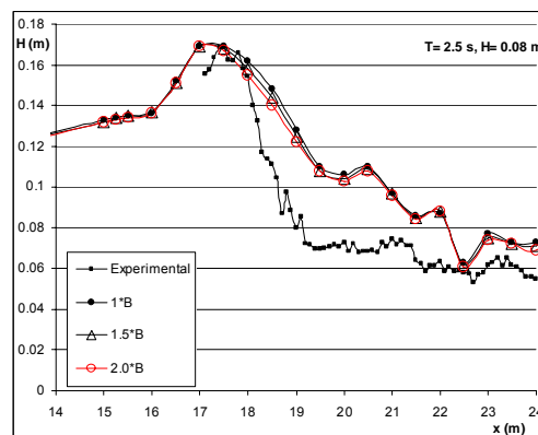
Figura 13: Variação uniforme de B. Valores numéricos e experimentais da altura de onda média quadrática. Caso de teste: T=2.5 s e H=0.08 m.
