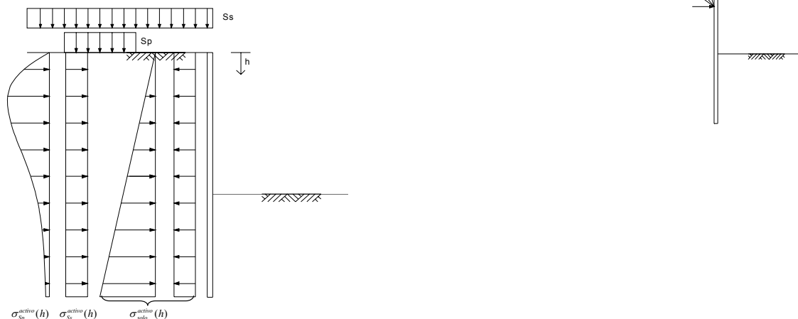
FIGURA 3: Diagrama de impulso activo no extradorso
