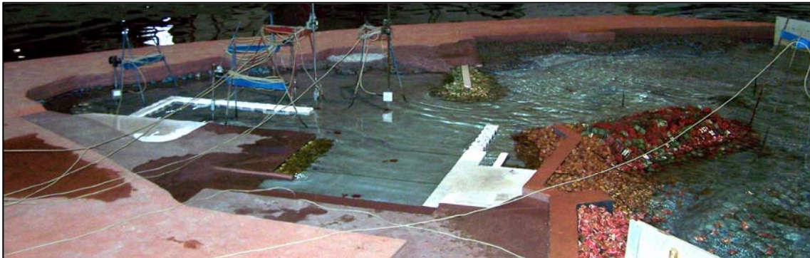
Fig. 14 – Ensaio em Modelo Reduzido das Obras de Melhoramento do Porto de S. Mateus
