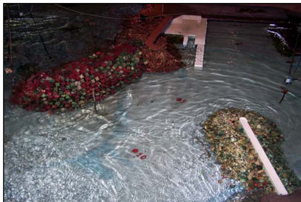
Fig. 15 – Ensaios no LNEC – Molhe e Contra-molhe
