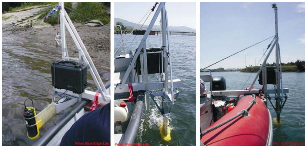
Figura 8: Estrutura modular em diferentes cenários de operação
