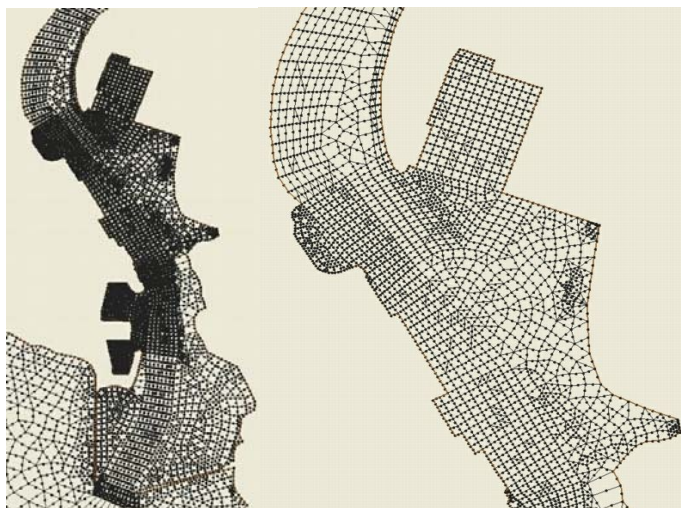
Figura 7 – Malha de elementos finitos, na zona do estuário; detalhe parcial, na zona do cais comercial e porto de pesca.
