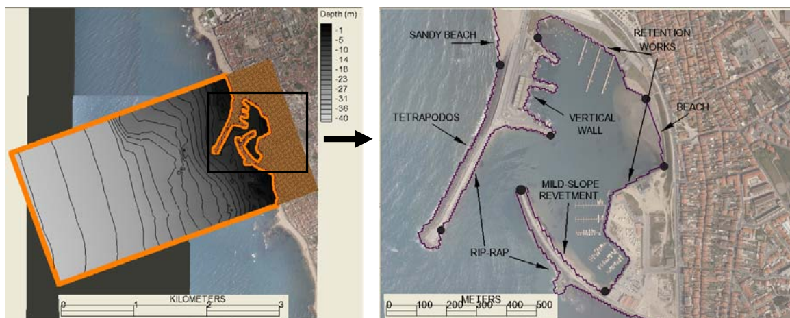
Figura 2 – Localização das camadas amortecedoras nas fronteiras do domínio de cálculo (esquerda) e pormenor do porto (direita).
