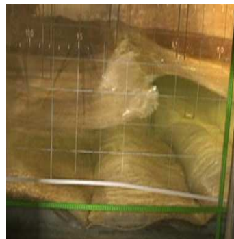
Figura 12. Rebentação observada nos ensaios para h = 0.87 m, H = 0.15 m e T = 2.84 s
