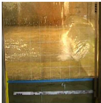
Figura 12. Rebentação observada nos ensaios para h = 0.87 m, H = 0.15 m e T = 2.84 s
