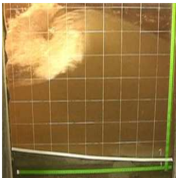
Figura 12. Rebentação observada nos ensaios para h = 0.87 m, H = 0.15 m e T = 2.84 s
