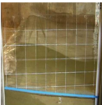
Figura 13. Rebentação observada nos ensaios para h = 0.87 m, H = 0.20 m e T = 2.52 s.
