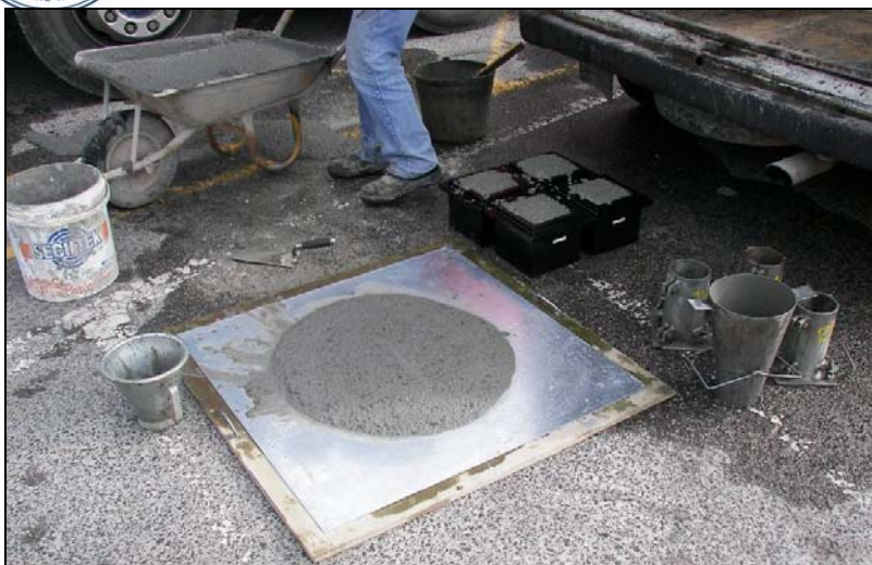
Fig. 8 – Verificação da consistência do betão
