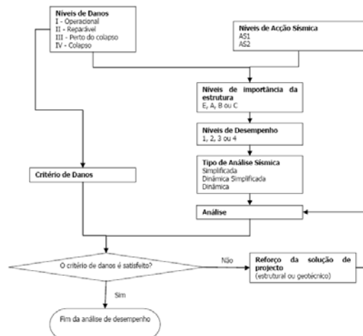
Figura 3.1– Fluxograma para avaliação do desempenho sísmico, aplicado às estruturas portuárias de gravidade, in [12].
