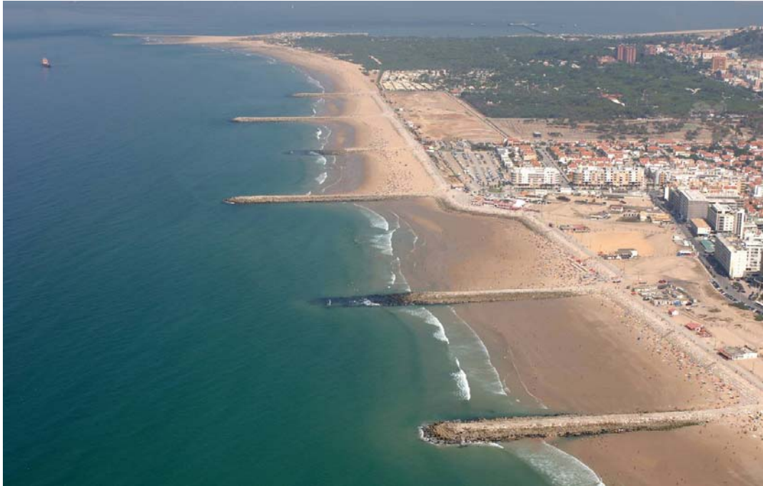
Figura 11. Frente urbana da Costa da Caparica e praia de S. João (em último plano) após a primeira alimentação artificial com areias.
