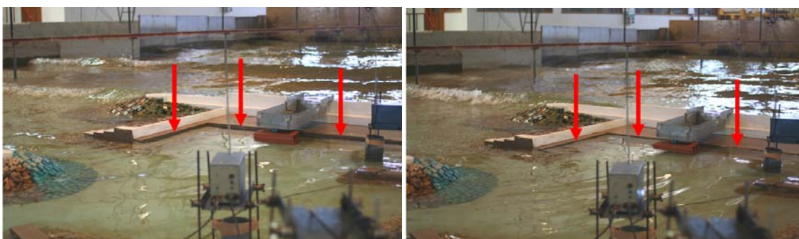
Fig. 10 – Exemplificação da elevação do nível de água no anteporto, visível junto ao cais
