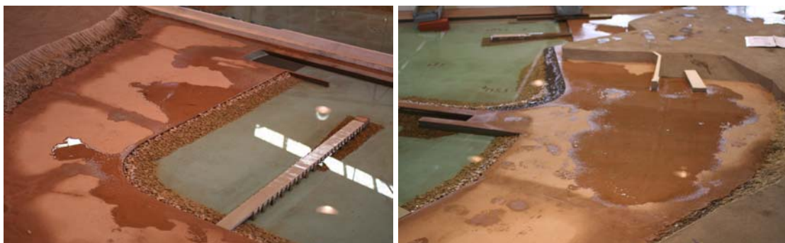
Fig. 11 – Inundação dos terraços do porto para a Solução Projetada, para o ensaio com o rumo N, nível de maré de PM, T_p = 14 s e H_s = 6,5 m
