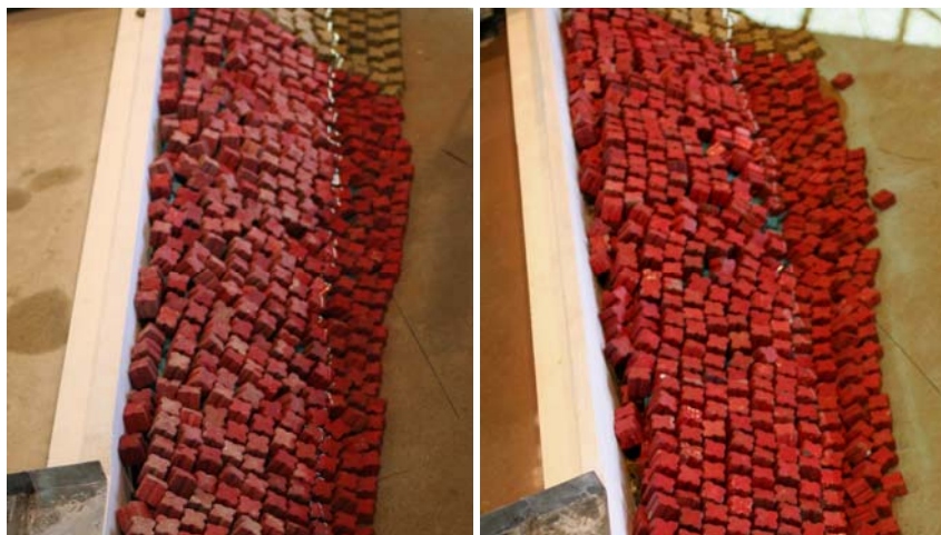
Fig. 12 – Situação Atual. Aspeto do tronco do molhe principal no ensaio com o rumo NNW, nível de maré de BM, Tp = 14 s: a) início do ensaio e b) após atuação de Hs = 6,0 m
