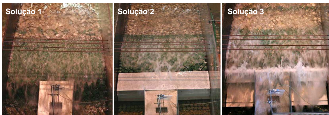
Figura 9: Galgamento observado durante os ensaios em modelo físico das soluções propostas para reabilitação final do molhe Oeste
