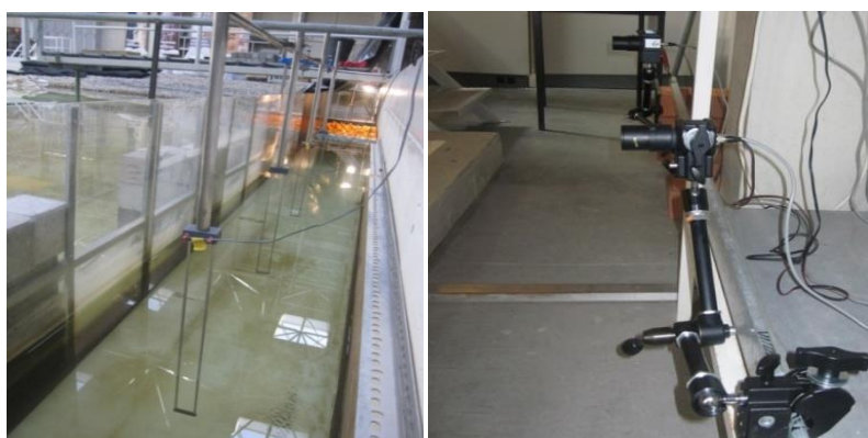
Figura 4 – Sondas hidrodinâmicas e equipamento vídeo.
