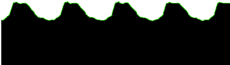
Figura 11 – Resultado da análise Edge Time Stack para o alinhamento 3 do teste 702, após binarização da imagem (ampliação). Note-se o desaparecimento do pequeno pico de espuma no topo das cristas e a linha, a verde, que define o contorno da superfície livre.
