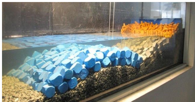
Figura 3 – Modelo construído do Quebramar Norte do Porto de Leixões.
