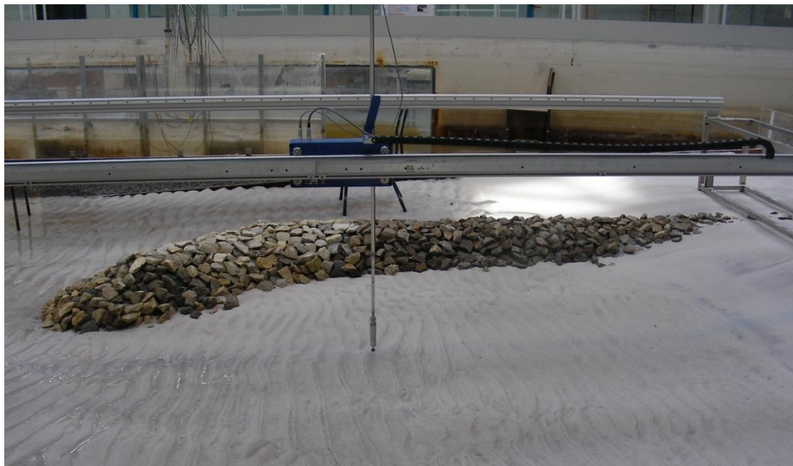
Figura 7. Ripples presentes no modelo físico durante a realização dos testes experimentais.
