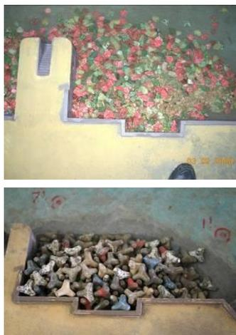
Fotos 17 e 18 – Estragos em manto de enrocamentos (sup.) e estabilidade de Tetrápodos (inf.),
