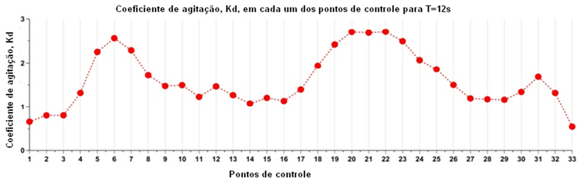
Figura 5. Variação do coeficiente de agitação, Kd, ao longo da parede do molhe (incidência normal e T_p=12 s)
