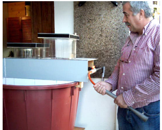
Ensaio com várias pressões, dos volumes de ar utilizados por uma componente de órgão (Dinarte Machado).
