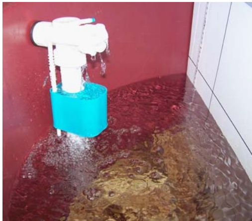
Pormenor da bóia reguladora e estabilizadora do nível de maré.
