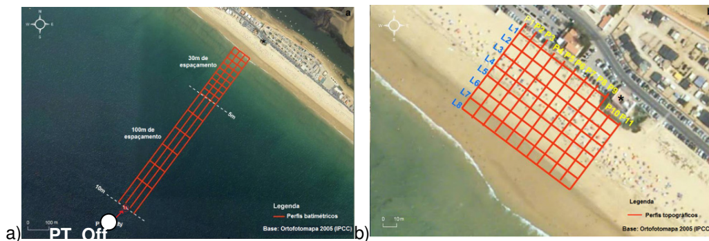
Figura 7 - Esquema dos levantamentos: (a) batimétrico (com identificação de local de instalação do transdutor de pressão – PT_Off) e (b) topográfico.
