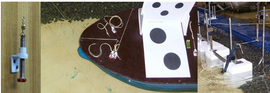
Figura 9 – Pormenor do mecanismo de ajuste das forças aplicadas nos cabos de amarração (esquerda); posição dos quatro mecanismos instalados à proa do modelo do navio (centro); dispositivo de simulação das defensas (direita).
