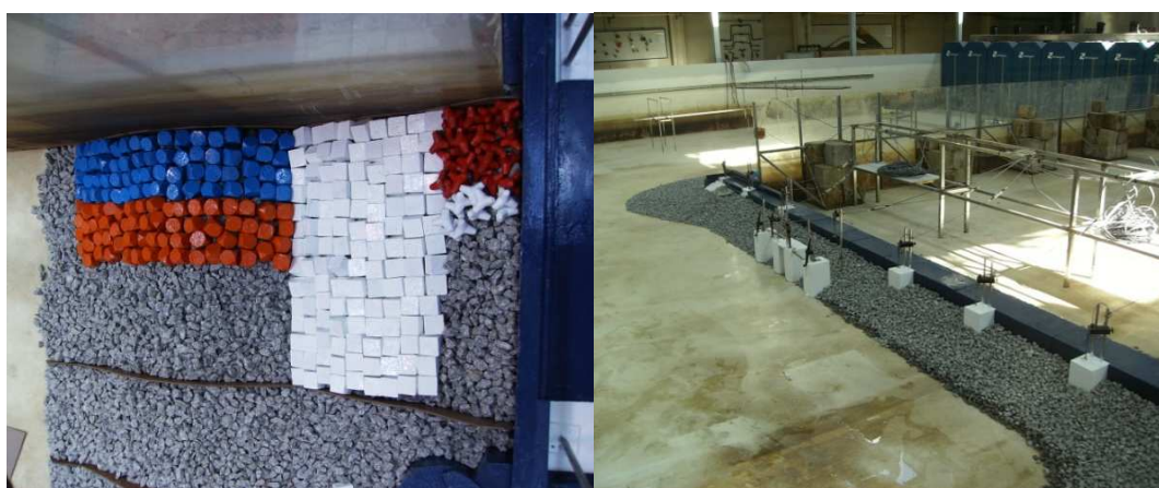
Figura 6 – Construção da cabeça do quebramar norte – a barlar (esquerda); intradorso do quebramar norte e Posto “A” (direita).
