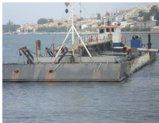
Fotografia 23 – Draga de sucção e arrasto
