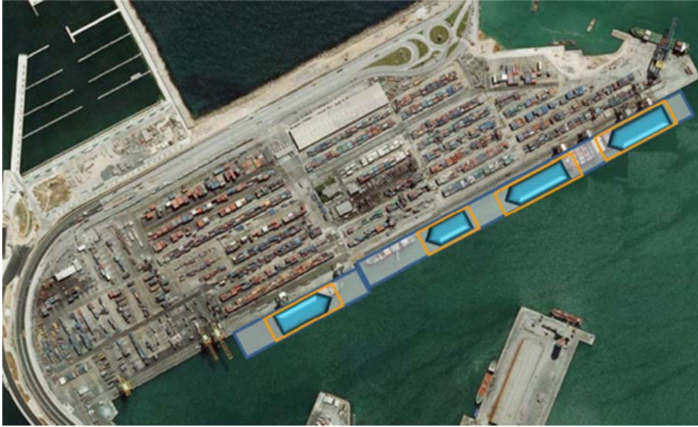
Figura 8: Muelle de la terminal TCV explotado como un muelle continuo. Situación 1. Fuente: Visor SigPac y elaboración propia.
