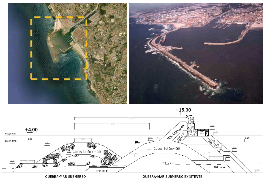
Figura 1 – Porto de Leixões e secção transversal do quebra-mar Norte do porto de Leixões.
