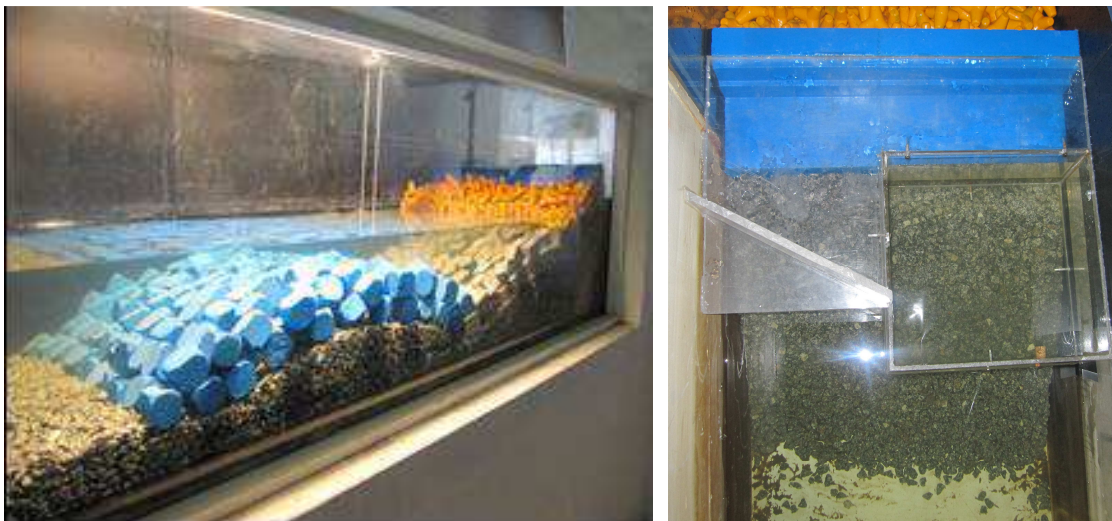
Figura 2 - Configuração do modelo físico e tanque para medição do volume galgado.
