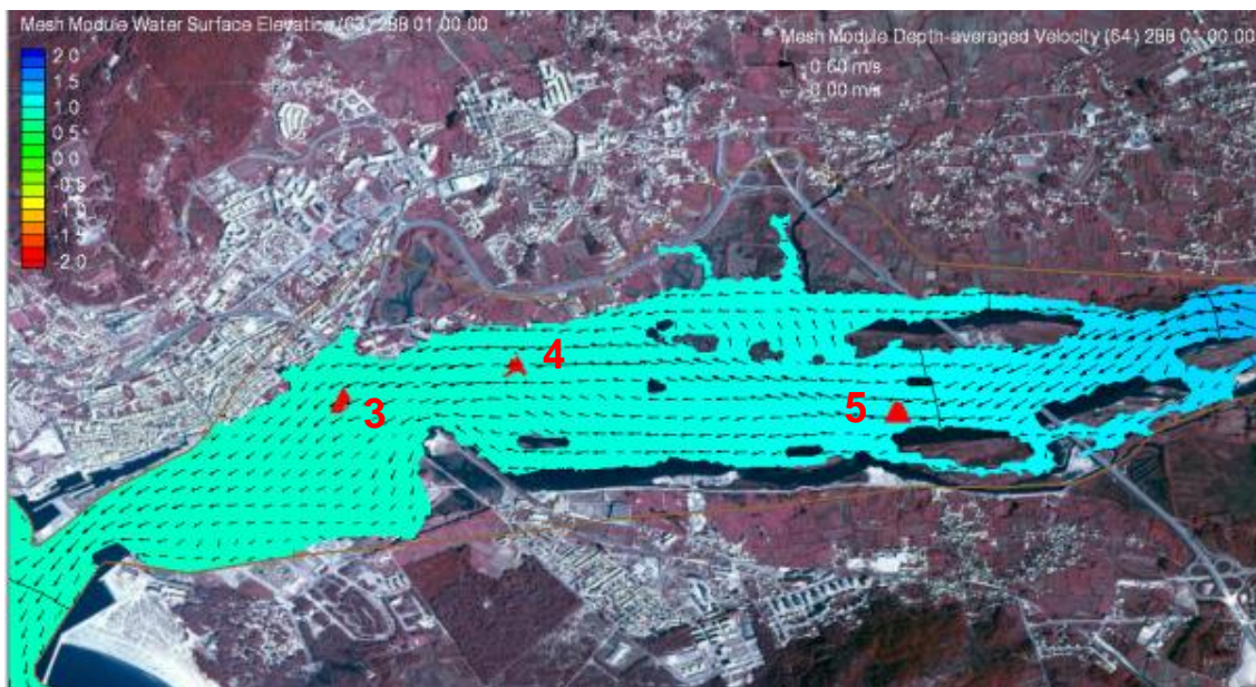
Figura 10 – Níveis e campo de velocidades obtidos para a simulação com forçamento astronómico, meteorológico e caudal fluvial em 17 Outubro 1987 01:00UTM.
