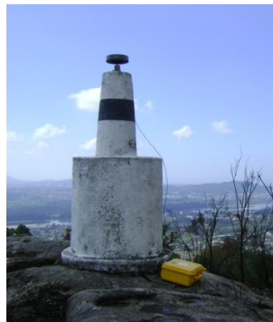
Figura 1 – Equipamento GNSS utilizado na aquisição de informação topo-batimétrica (esquerda) e equipamento utilizado para aquisição de informação de elevada precisão para correção diferencial e estabelecimento do MLOG (direita).
