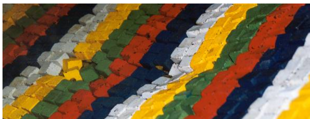
Figura 2. Efeito da aplicação de enrocamento de reduzida dimensão na subcamada.
