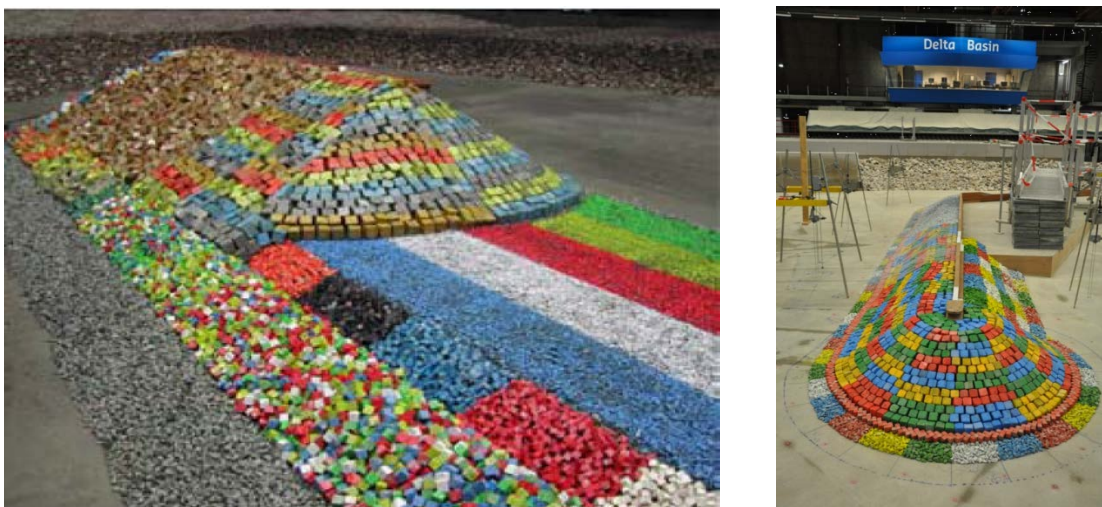
Figura 9. Ensaios em modelo físico reduzido das cabeças provisórias em mantos de camada única em Cubos em Punta Langosteira (esquerda) e Cubos em camada única na cabeça do quebra-mar de Sal Rei na Ilha da Boa Vista (direita).
