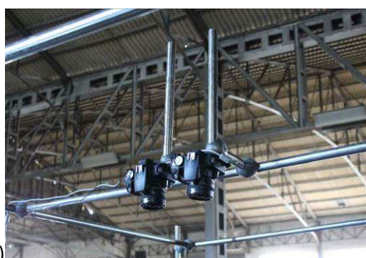
Figura 9. a) Vista do modelo tridimensional b) Instalação das câmaras sobre o modelo e aquisição das imagens através de dois computadores portáteis
