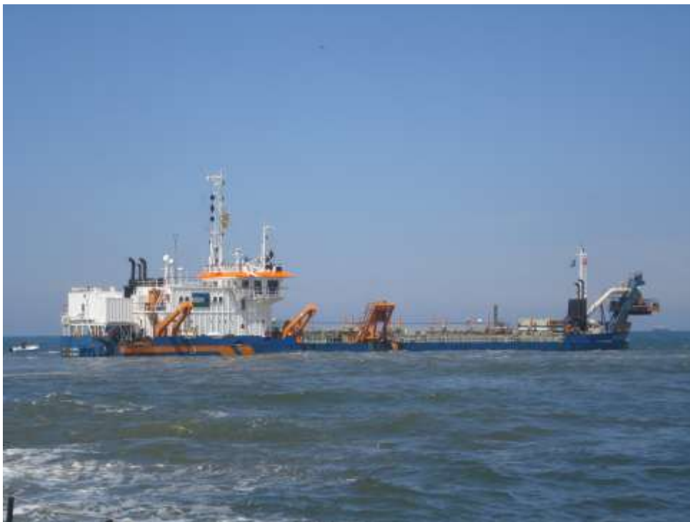
Figura 12 – Dragagem utilizada nas dragagens de construção (valas de fundação)
