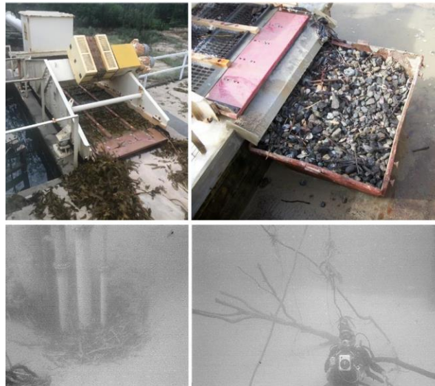
Figura 5. TRESBP, na Austrália. Tela de gradagem vibratória, pedras e seixos extraídos da mistura, fragmentos de madeira junto aos cones de extração e tronco de grandes dimensões na trincheira de areias.
