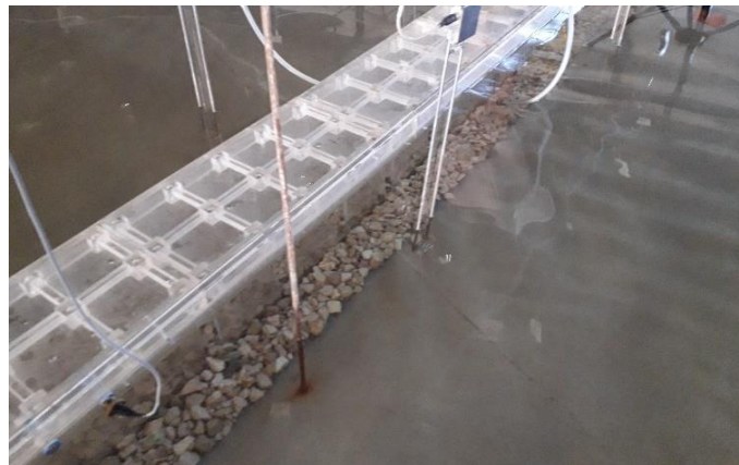
Figura 3. Cortina de abrigo da Ponte-cais com 15 aberturas, em modelo Reduzido.
