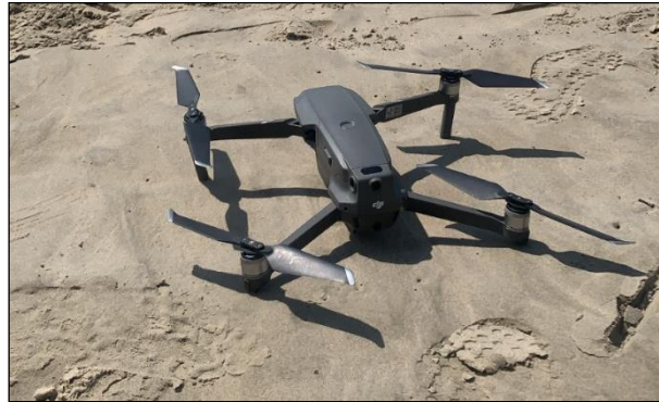
Figura 1. Modelo de drone DJI Mavic 2 PRO. Equipamento utilizado para realização dos levantamentos aerofotogramétricos
