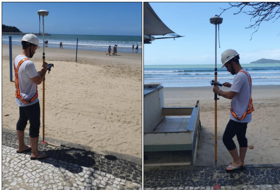
Figura 5. Levantamento topográfico planialtimétrico dos perfis praias na orla da Praia Central de Balneário Camboriú, através de receptores GNSS com tecnologia RTK.
