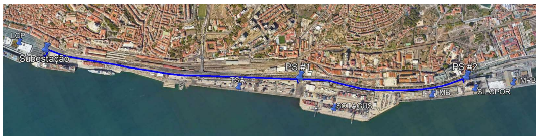
Figura 17 – Traçado previsto para a rede interna de 10 kV e Postos de Seccionamento
