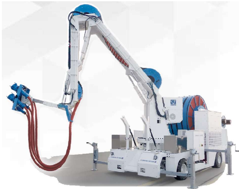
Figura 19 – Veículo Shore CONNECT da Stemman-Technik [7]
