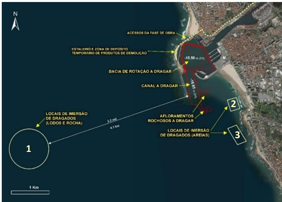
Figura 2 - Implantação do projeto das acessibilidades marítimas (com indicação da localização dos três depósitos de imersão de material rochoso não aproveitado: 1- Vazadouro a 2,2 milhas; 2 e 3 – frente do Castelo do Queijo)
