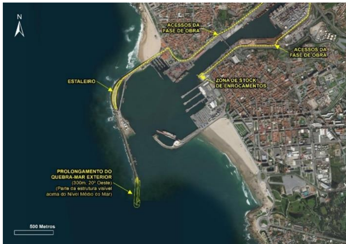
Figura 3 - Implantação do projeto do prolongamento do quebra-mar
