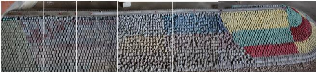
Figura 6. Configuração inicial dos ensaios em 2017 – Vista do extradorso: extensão com manto colocado de forma regular e irregular.
