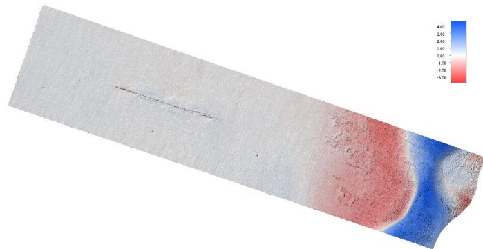
Figura 6. Superfície batimétrica representativa das diferenças entre LH2020 vs LH2017.
