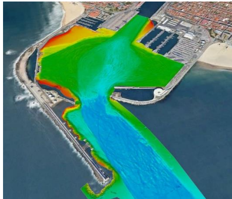
Figura 4. Imagens georreferenciadas do modelo batimétrico correspondente ao levantamento final no Porto de Leixões.
